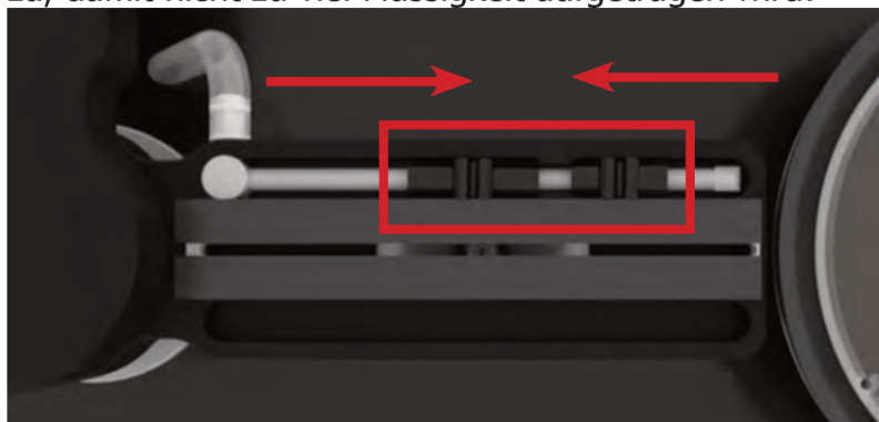
Abb. 9: Einstellung zur Reinigung von 7 Zoll Schallplatten
