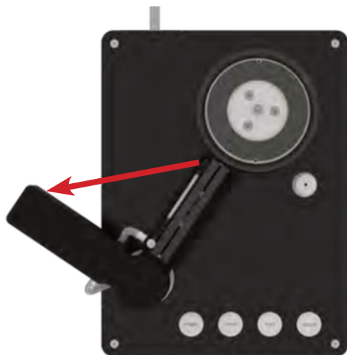
Abb. 7: Öffnen der Reinigungs- und Absaugeinheit
