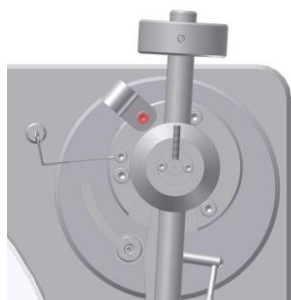
Bild 3: Befestigung der Kabelführung an der Tonarmbasis
